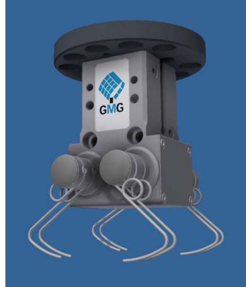
Standardvariante mit 4 Nadelwellen und 2 Nadeln pro Nadelwelle
